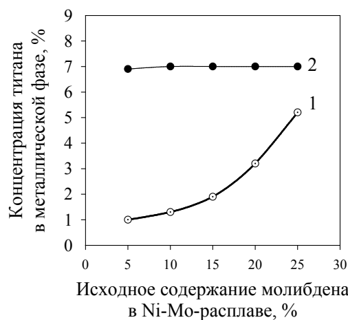
Рис. 2.6.5. Зависимость концентрации титана в металлической фазе от исходного содержания молибдена в расплаве: TiC 0,96 / Ni-Mo, 1450°C, 1- 1 час; 2 – 25 час
